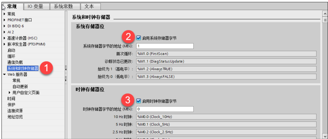
图 4-4-4 启用系统存储器与时钟存储器
